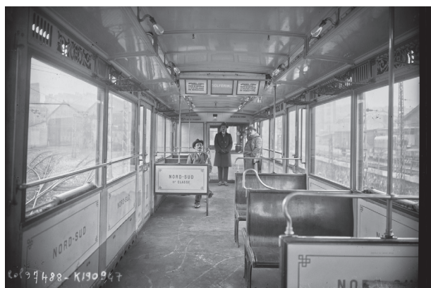
APARATOS LUMINOSOS SEÑALANDO LAS ESTACIONES. DENTRO DE LOS TRENES. FUENTE: BNF.
