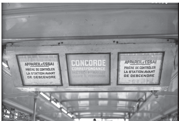
APARATOS LUMINOSOS SEÑALANDO LAS ESTACIONES. DENTRO DE LOS TRENES. FUENTE: BNF.
